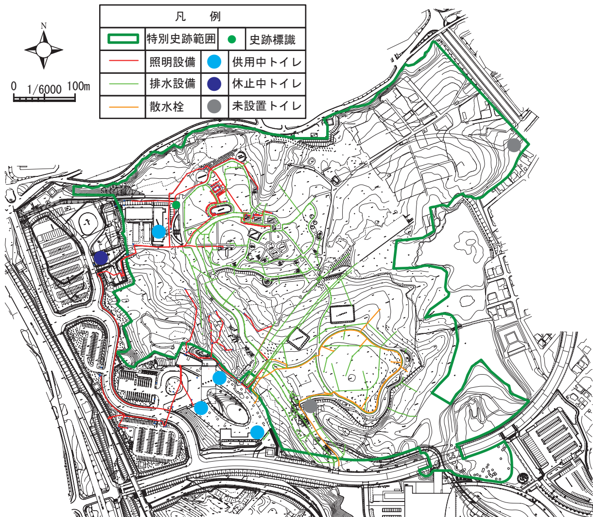
図 43 トイレ、配電、排水施設及び散水栓の設置状況図（主要なもののみ）
